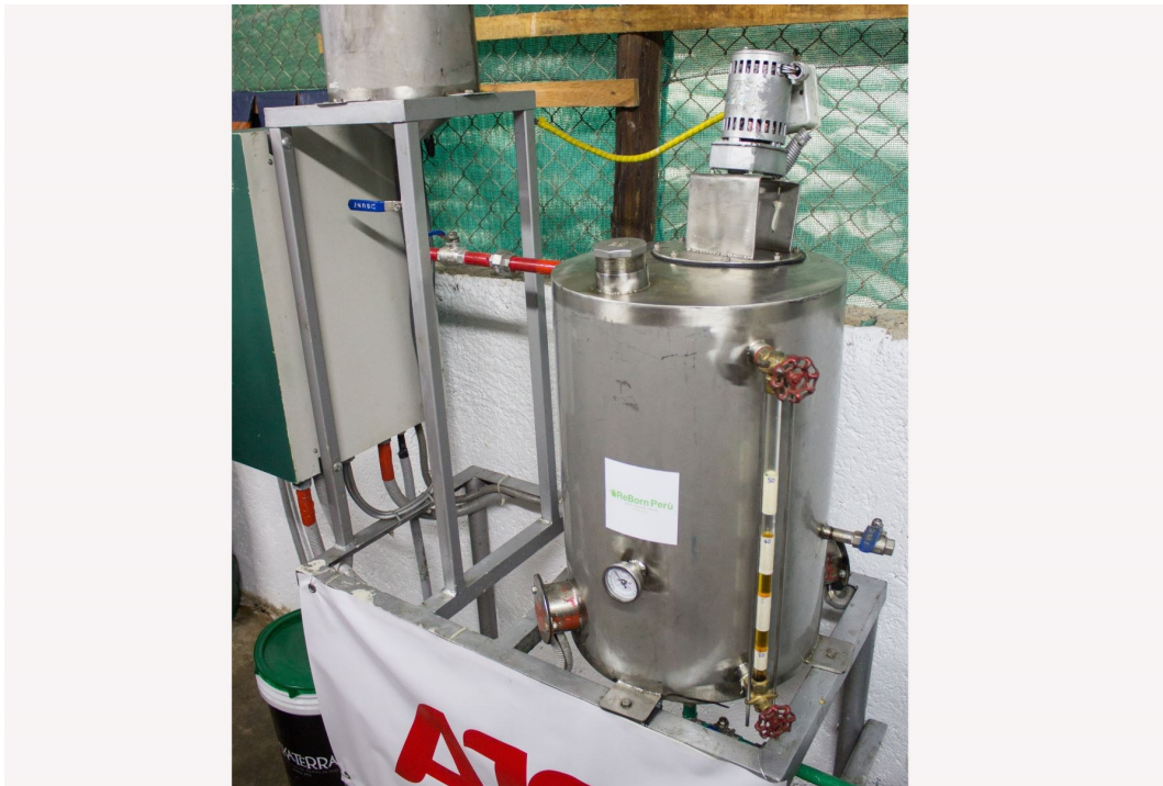
El tanque de esta Planta de transformación de aceite usado de cocina convierte 50 litros de biodiesel
